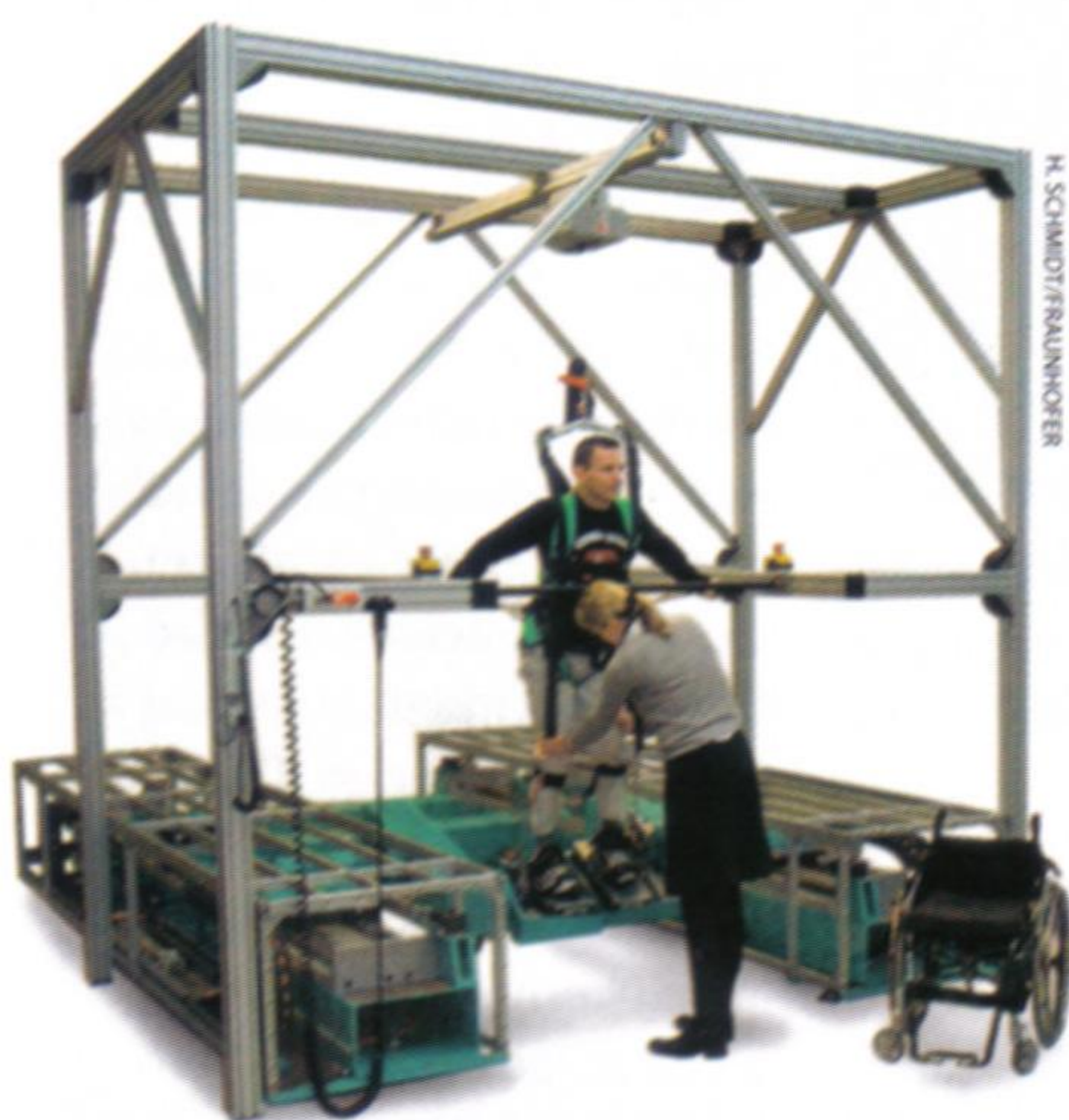
Stativet lyfter den delvis förlamade patienten och stöder övningarnas rörelser.
