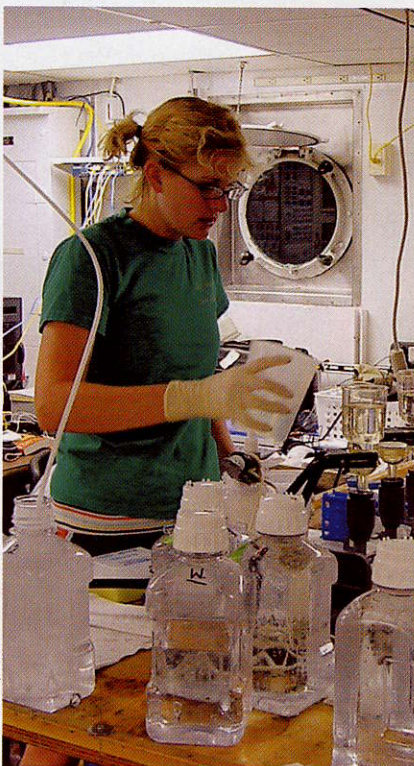
Vattenprover analyseras på fartyget R/V Oceanus. Forskarassistenten Sarah Bender mäter förhållandet mellan näringsämnen och växtplankton.
