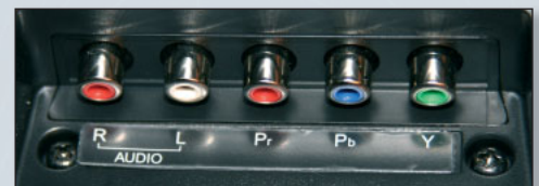
Analog. Komponentanslutningen ser ut så här, och är faktiskt en analog ingång.
