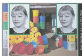
Jämför. Till vänster ett digitalt original och till höger utskriften. Som synes blir bilden grovkornig och har dålig kontrast. Viss randning förekommer.
