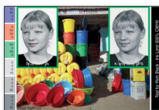
Jämför. Till vänster ett digitalt original och till höger utskriften. Som synes blir bilden grovkornig och har dålig kontrast. Viss randning förekommer.
