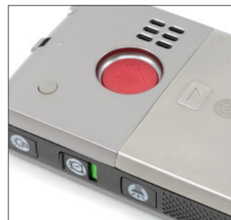
LARMKNAPP. På baksidan av telefonen sitter en stor röd knapp. Ett tryck på den ringer upp förprogrammerade nödnummer.
