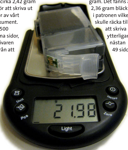
Noggrann vägning. Vi vägde löpande patronen för att på så sätt beräkna bläckförbrukningen. Vågen mäter med en noggrannhet på 0,01 gram.
