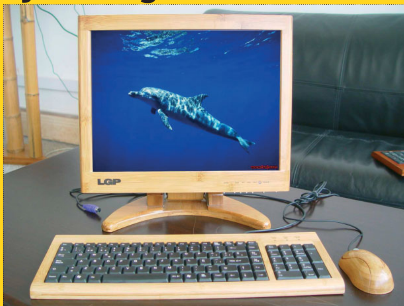
Träskönt. När trä ersätter plast blir datordelarna biologiskt nedbrytbara.
