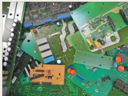
Kretskort. Här finns bromerade flamskyddsmedel.
