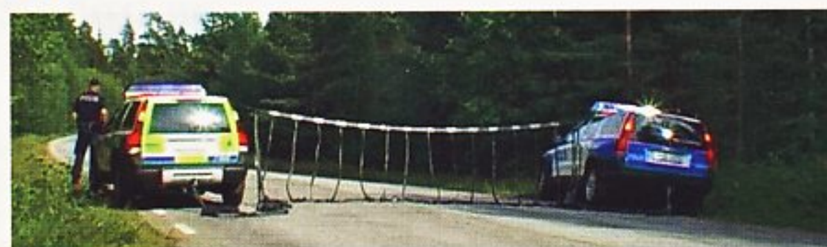
Fångar personbilar. Nätet är testat på bilar upp till 2,5 ton som kör 200 kilometer i timmen.
