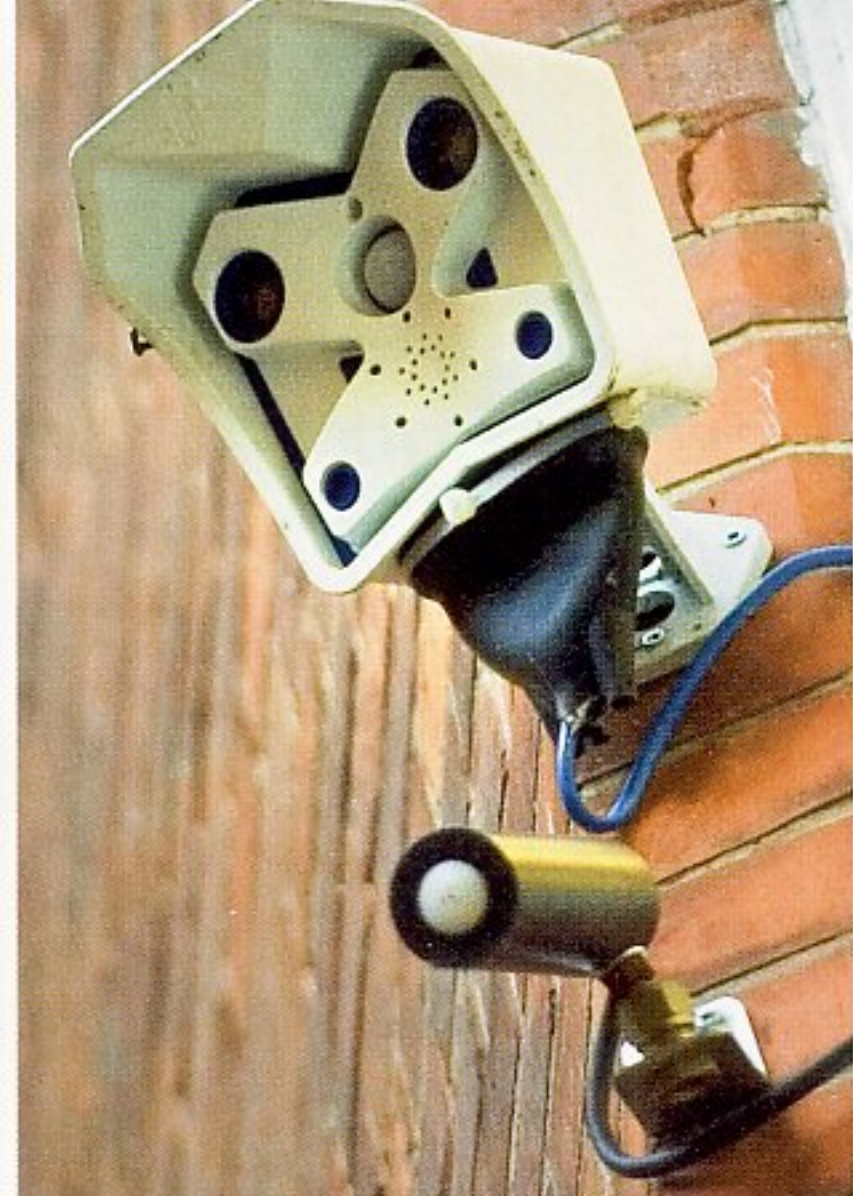
4 Ser och hör. Mikrofonen under kameran märker om röster i närheten är aggressiva. Denna kamera finns i Groningen, Nederländerna.
