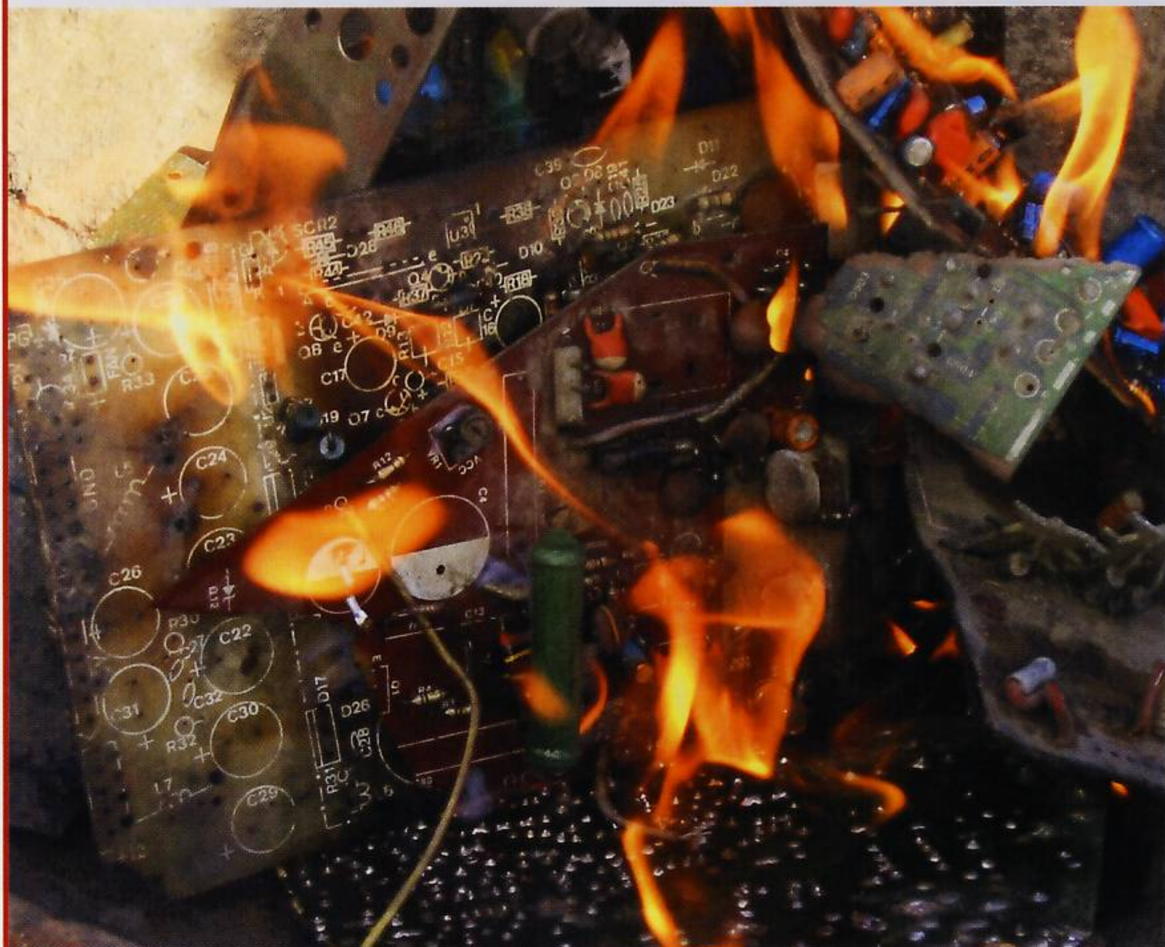
5 Eldning. Den enklaste metoden för att öka metallhalten är att bränna e-skrotet.
